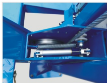
气缸。 Air cylinder.
