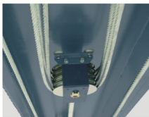
倍增滑轮结构。 Multiplying pulley structure.
